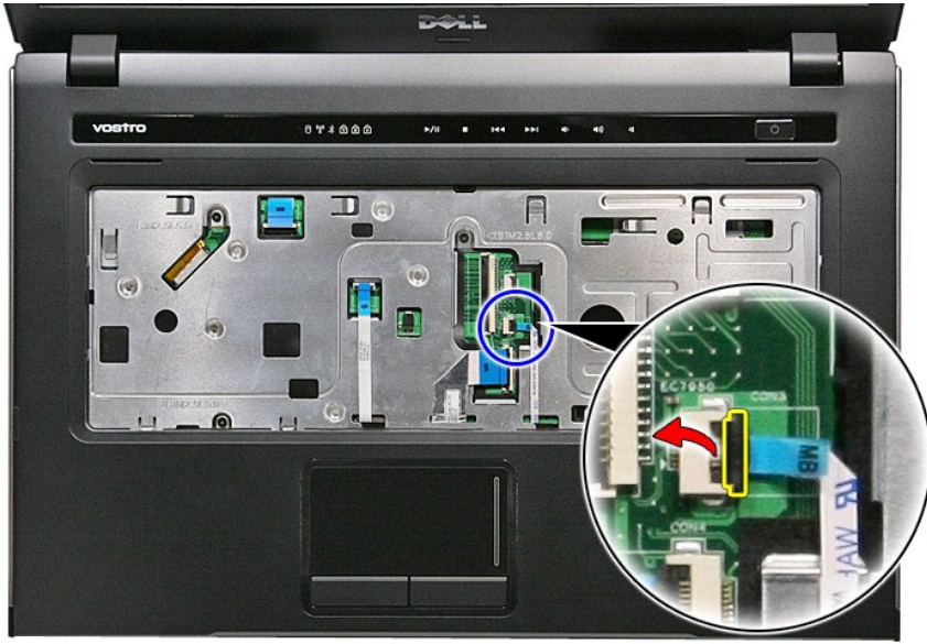
17. Parmakizi okuyucu kablosunu sistem kartı üzerindeki konnektöründen çıkarın.
